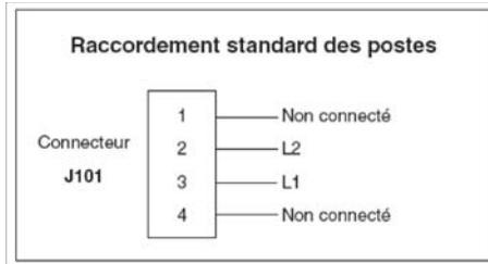
Le raccordement des postes nécessite une paire. L'utilisation d'un câble écranté raccordé à la terre côté répartiteur général est préconisée.
