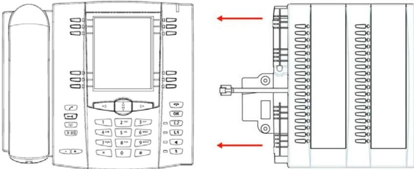
Le module d'extension permet d'équiper le poste de 36 touches programmables supplémentaires. Pour mettre en place le module d'extension :
